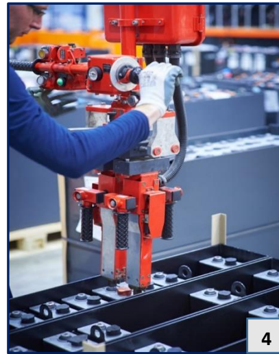
Şekil - 64. Plakaların Birleştirilerek Hücre Haline Getirilmesi (1,2) ve Kutulara Montajı (3,4)
