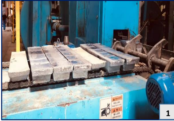
Şekil - 23. Külçelerin Konveyöre Yerleştirilmesi (1) ve Kesme İşlemi (2)
