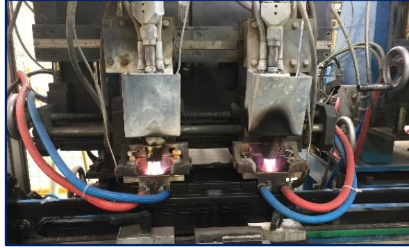
Şekil - 41. Kutup Başı Kaynağı
