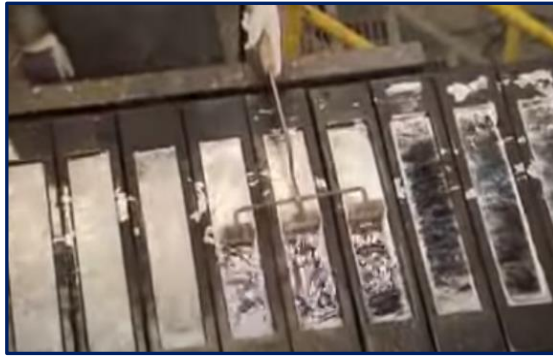
Şekil - 85. Ergitilen Kurşunun Kalıplara Dökülmesi ve Yüzeydeki Cürufların Sıyırılması
