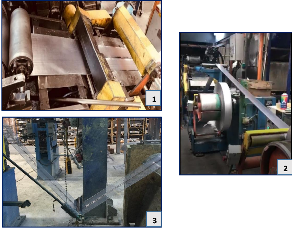
Şekil - 28. Kurşun Levhaların Kesilmesi (1), Kasnağa Sarılması (2) ve Izgara Geometrisi Verilmesi (3)
