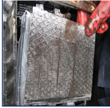
Şekil - 13. Sülfatlaşma Meydana Gelmiş Plaka
