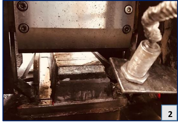
Şekil - 23. Külçelerin Konveyöre Yerleştirilmesi (1) ve Kesme İşlemi (2)
