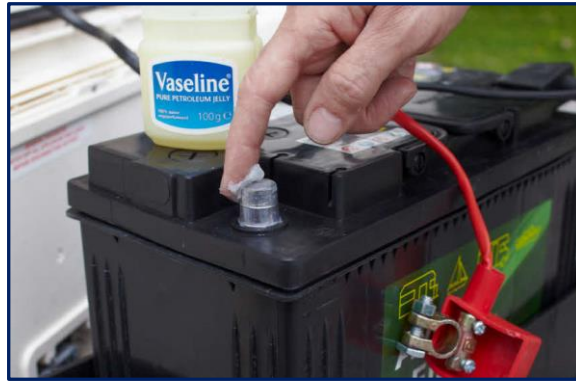
Şekil - 68. Kutup Başlarının Vazelinlenmesi
