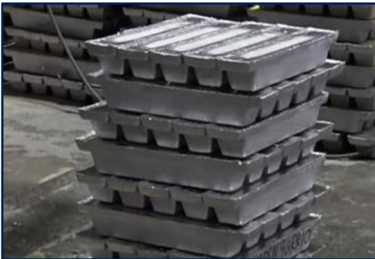
Şekil - 86. Kalıp Haline Getirilmiş Kurşunlar
