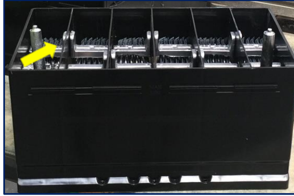
Şekil - 37. Griftlenerek kutulara Yerleştirilmiş Plaka Grubu
