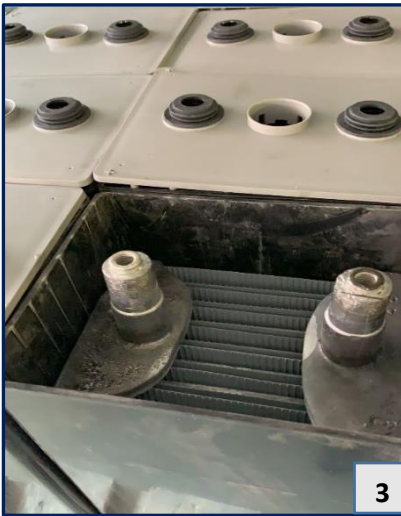
Şekil - 64. Plakaların Birleştirilerek Hücre Haline Getirilmesi (1,2) ve Kutulara Montajı (3,4)
