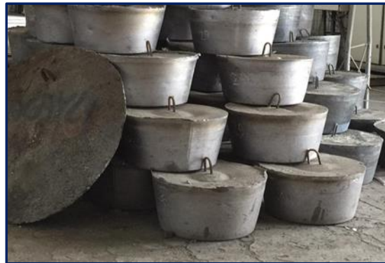
Şekil - 86. Kalıp Haline Getirilmiş Kurşunlar
