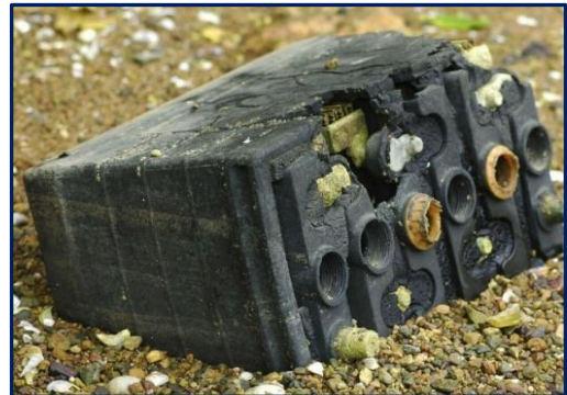
Şekil - 92. Toprağa Bırakılmış Atık Akü
