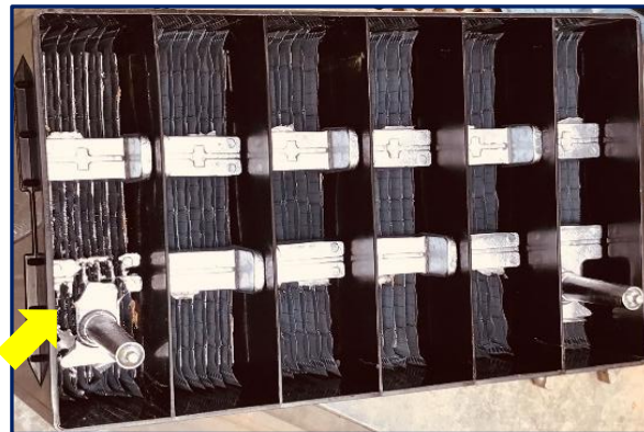
Şekil - 38. Kısa Devre Kontrolü ve Montaj Hattından Ayrılmış Hatalı Akü
