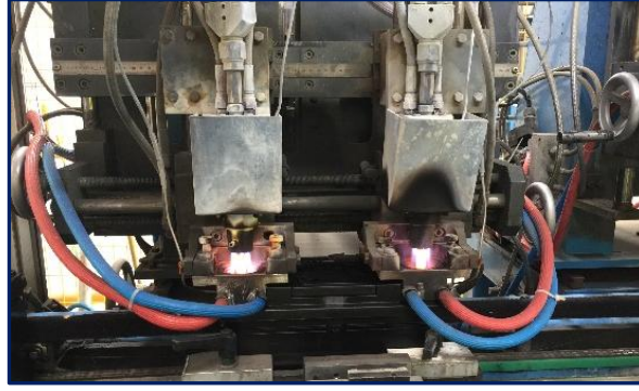
Şekil - 41. Kutup Başı Kaynağı
