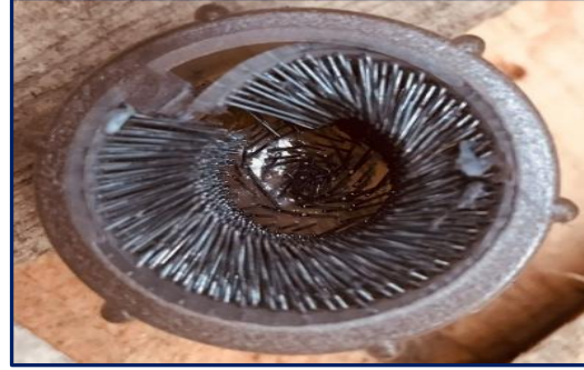
Şekil - 50. Kutup Başı Fırçalama
