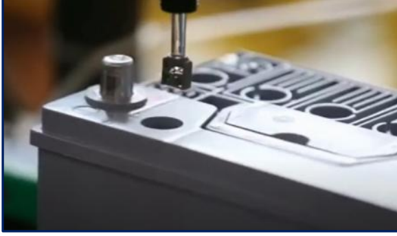
Şekil - 47. İndikatör ve Buşon Takılması, Montaj
