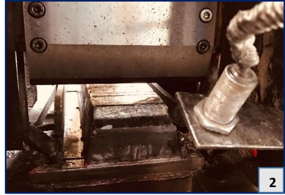
Şekil - 23. Külçelerin Konveyöre Yerleştirilmesi (1) ve Kesme İşlemi (2)
