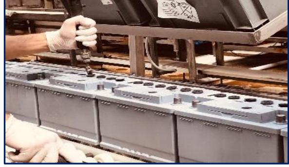
Şekil - 47. İndikatör ve Buşon Takılması, Montaj
