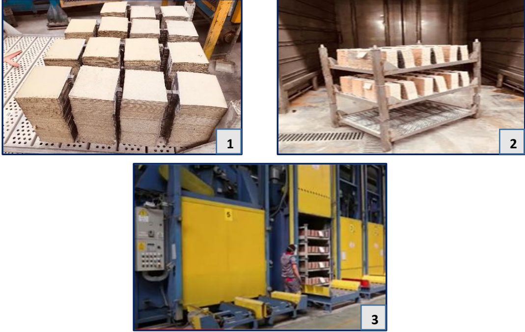
Şekil - 31. Plakaların Raf Arabalarına Dizimi (1), Kürleme Odasına Alımı (2) ve Kürleme-Kurutması (3)
