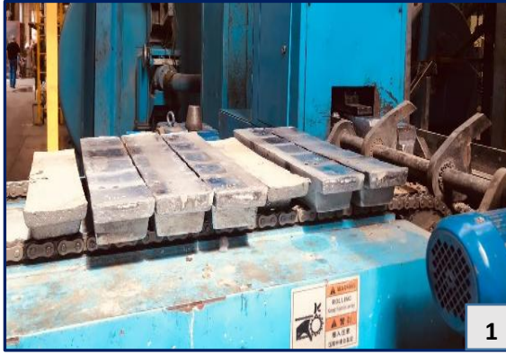
Şekil - 23. Külçelerin Konveyöre Yerleştirilmesi (1) ve Kesme İşlemi (2)
