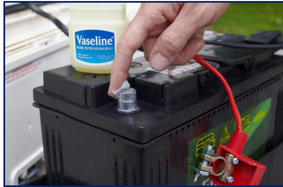
Şekil - 68. Kutup Başlarının Vazelinlenmesi
