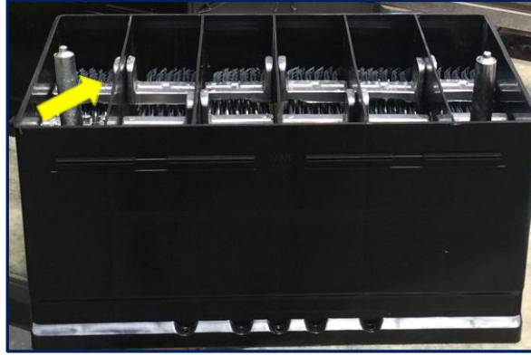
Şekil - 37. Griftlenerek kutulara Yerleştirilmiş Plaka Grubu
