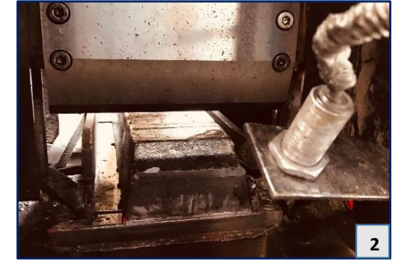
Şekil - 23. Külçelerin Konveyöre Yerleştirilmesi (1) ve Kesme İşlemi (2)
