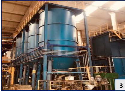
Şekil - 22. Potada Eritme (1), Misket Döküm (2) ve Silolarda Depolama (3)
