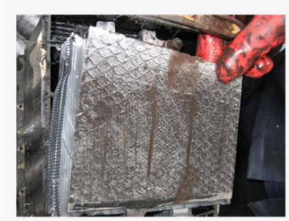
Şekil - 13. Sülfatlaşma Meydana Gelmiş Plaka
