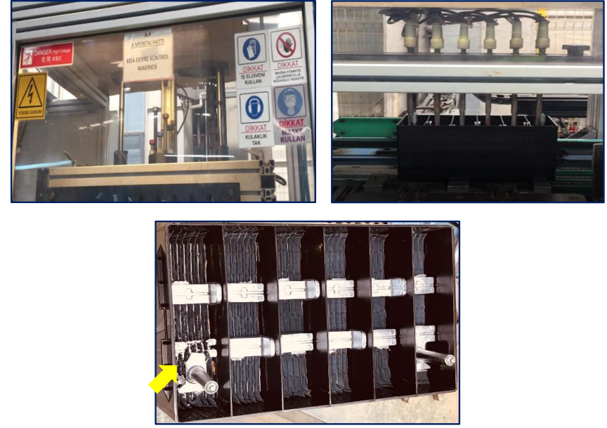
Şekil - 38. Kısa Devre Kontrolü ve Montaj Hattından Ayrılmış Hatalı Akü
