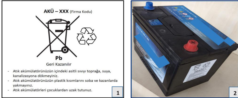
Şekil - 77. APAK Yönetmeliği'ne Göre Akülerin ve Ambalajlarının Üzerinde Olması Gerekli Bilgi ve Semboller (1), APAK ve TS EN e Göre Etiketlenmiş Akü (2)
