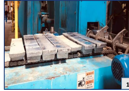
Şekil - 23. Külçelerin Konveyöre Yerleştirilmesi (1) ve Kesme İşlemi (2)
