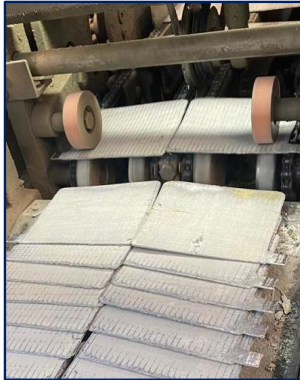
Şekil - 29. Gravity Yöntemi Plaka Üretimi
