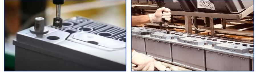
Şekil - 47. İndikatör ve Buşon Takılması, Montaj
